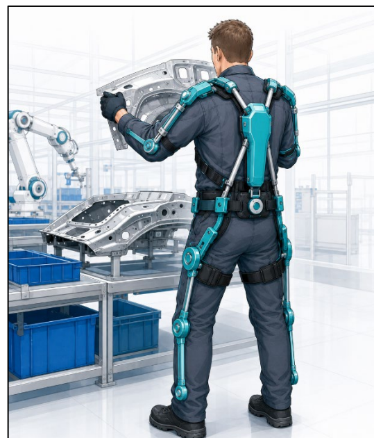
Abbildung 3: Exoskelette sind mechanische Stützstrukturen zur Entlastung bestimmter Körperregionen
